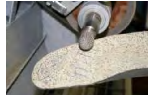
6. Vertiefung für Mittelfußköpfchen schleifen
